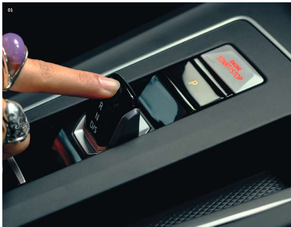
01 Dwusprzęgłowa przekładnia DSG z nową, małą dźwignią selekcyjną gwarantuje przyjemność jazdy, której nie zakłócają przerwy siły ciągu. Naciskając na dźwignię, wybiera się żądany bieg, który jest realizowany przez połączoną elektrycznie przekładnię Shift by Wire. S
